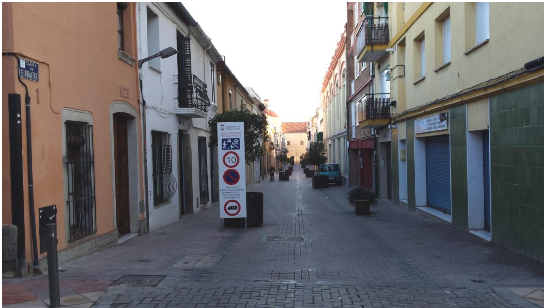
Imatge 92 Exemple de configuració de vies en plataforma única amb ús de mobiliari. Municipi de Premià de Mar.
