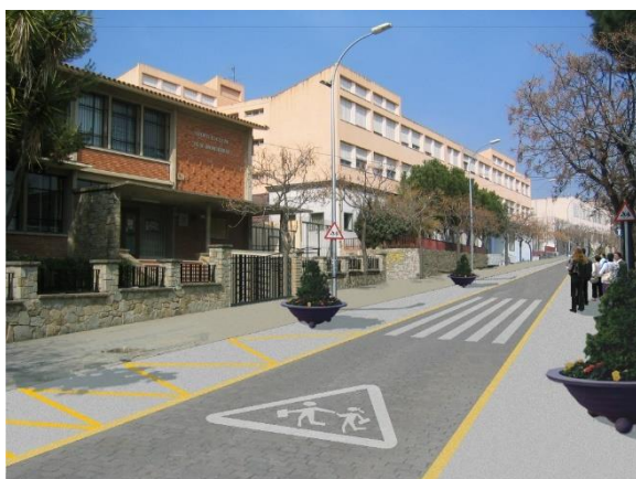
Figura 81 Fotomuntatge proposta de carrer amb paviment únic i preferència per a vianants. Velocitat límit de 20 km/h.
