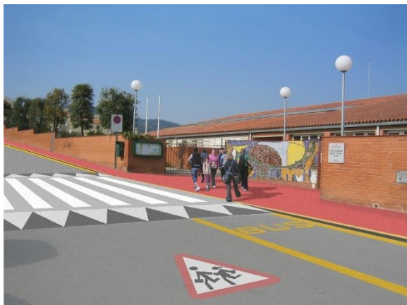
Figura 77 Fotomuntatge proposta de plataforma sobreelevada que cobreixi tot l'entorn d'accés a l'escola i que inclogui parada de transport col·lectiu i diferents elements de mobiliari urbà.
