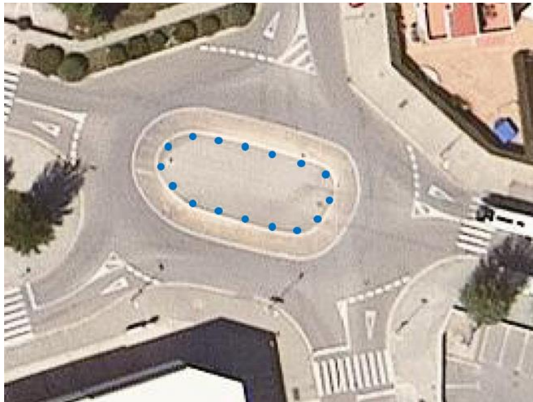
Imatge 72 Exemple de balisament de l'interior de la rotonda.
