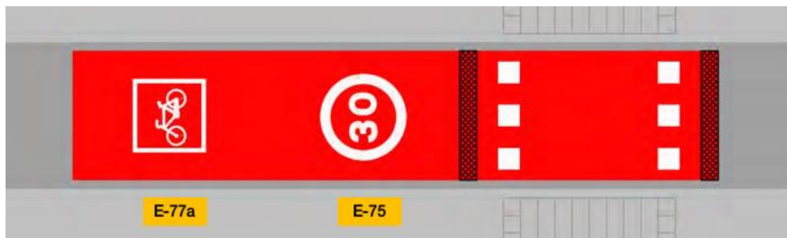
Figura 65 Exemple d'accés a carrer de zona 30: Pas de vianants elevat per reduir la velocitat dels vehicles i senyalització horitzontal.
