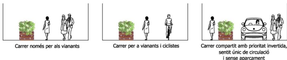
Figura 34. Possibles seccions per a carrers amb menys de 7 m d'amplada
