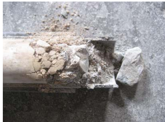
Foto 12. Detall de la mostra extreta mitjançant l'assaig SPT1 del S2 a 1.00 m de fondària.
