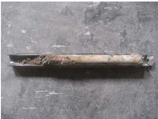
Foto 11. Mostra extreta mitjançant l'assaig SPT1 del S2 a 1.00 m de fondària.
