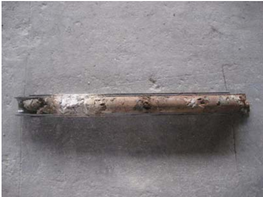
Foto 7. Mostra extreta mitjançant l'assaig SPT2 del S1 a 3.00 m de fondària.
