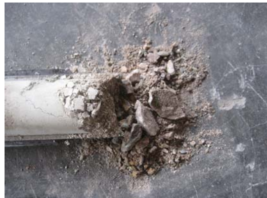
Foto 6. Detall de la mostra extreta mitjançant l'assaig SPT1 del S1 a 1.00 m de fondària.
