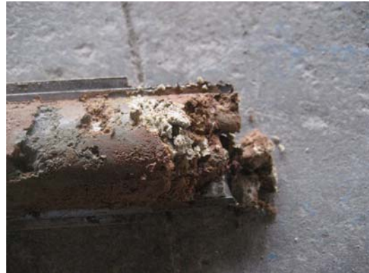
Foto 8. Detall de la mostra extreta mitjançant l'assaig SPT2 del S1 a 3.00 m de fondària.
