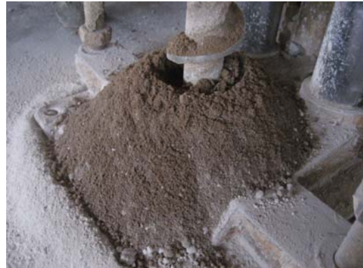
Foto 4. Detall del rípi extret mitjançant el sondeig S1.
