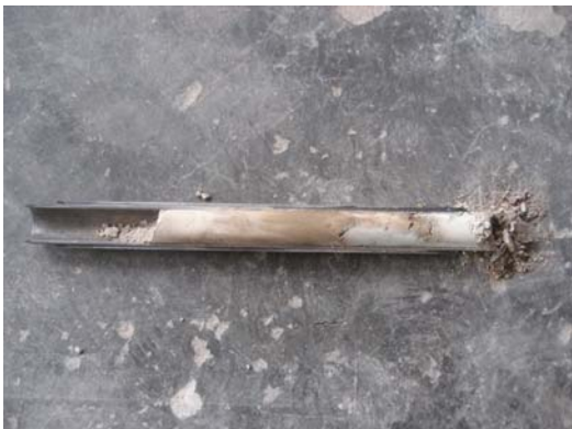
Foto 5. Mostra extreta mitjançant l'assaig SPT1 del S1 a 1.00 m de fondària.
