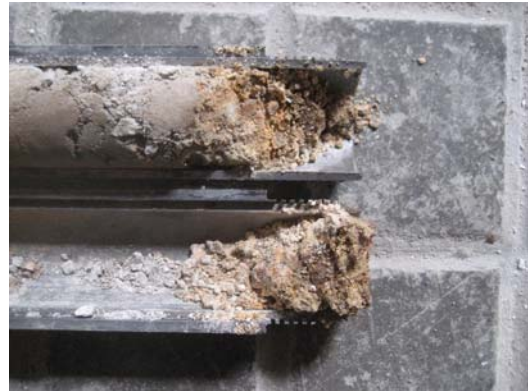
Foto 14. Detall de la mostra extreta mitjançant l'assaig SPT2 del S2 a 3.00 m de fondària.
