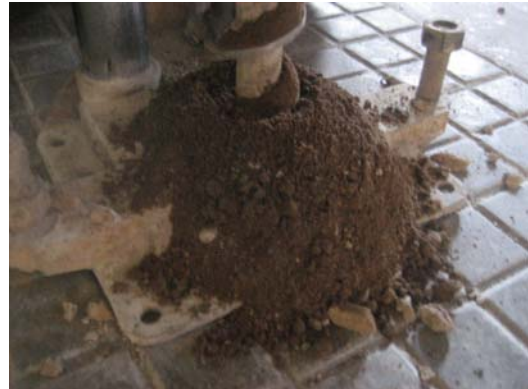
Foto 10. Detall del ripi extret mitjançant el sondeig S2.
