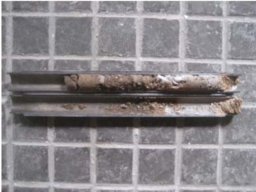
Foto 13. Mostra extreta mitjançant l'assaig SPT2 del S2 a 3.00 m de fondària.
